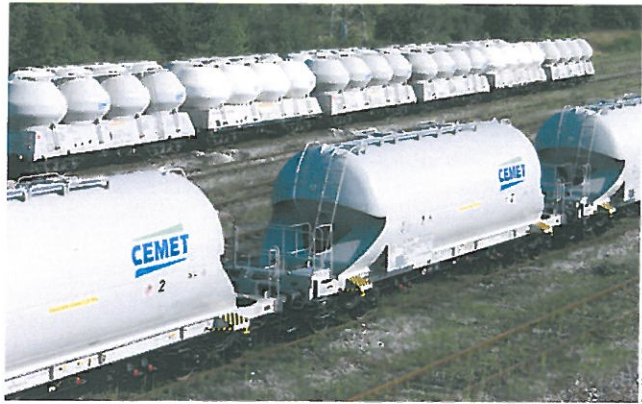
Wagony 440S na tle wagonów 408S – doskonale widoczna są zmiany jakie nastąpiły w konstrukcji wagonów do przewozu materiałów sypkich
